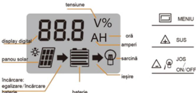
meniu: comutați între diferite afișaje sau pentru a intra / ieși din setare, prin apăsare lungă a tastei.
