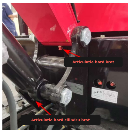
Fig. 11 - Gresoarele de la baza brațului și a cilindrului brațului
