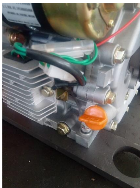
Fig. 14 – Motorul diesel: bușonul de umplere și bușonul de golire a uleiului
