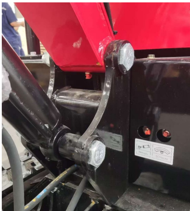
Fig. 13 – Zona de gresare a articulațiilor de la baza brațului
