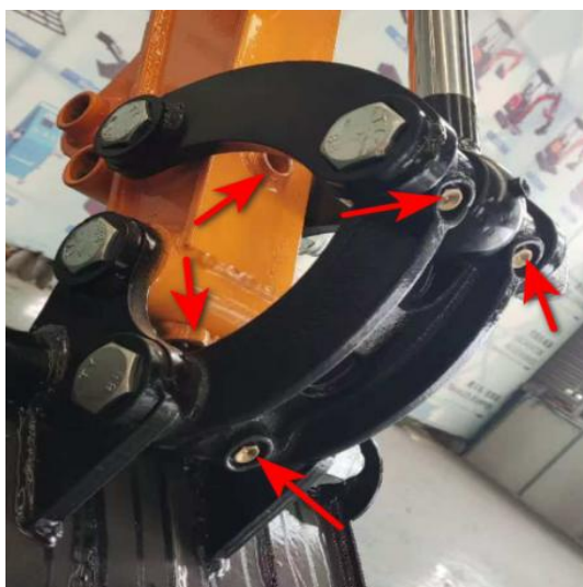
Fig. 10 - Punctele de gresare ale articulației cupă-bielă
