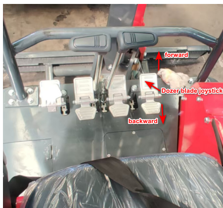
Fig. 6 – Acționarea lamei (forward = înainte/coborâre, backward = înapoi/ridicare)
