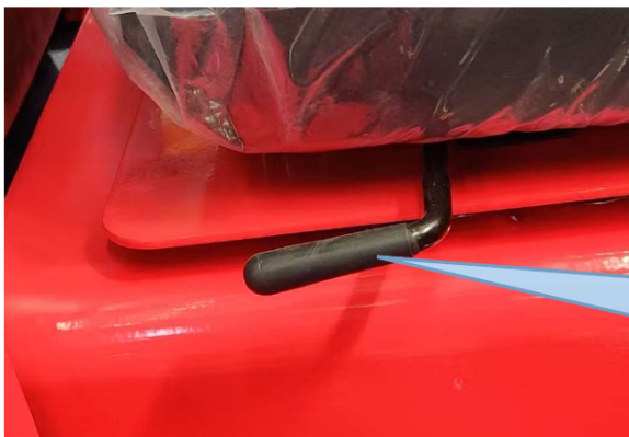
Fig. 8 – Maneta de reglare a scaunului
