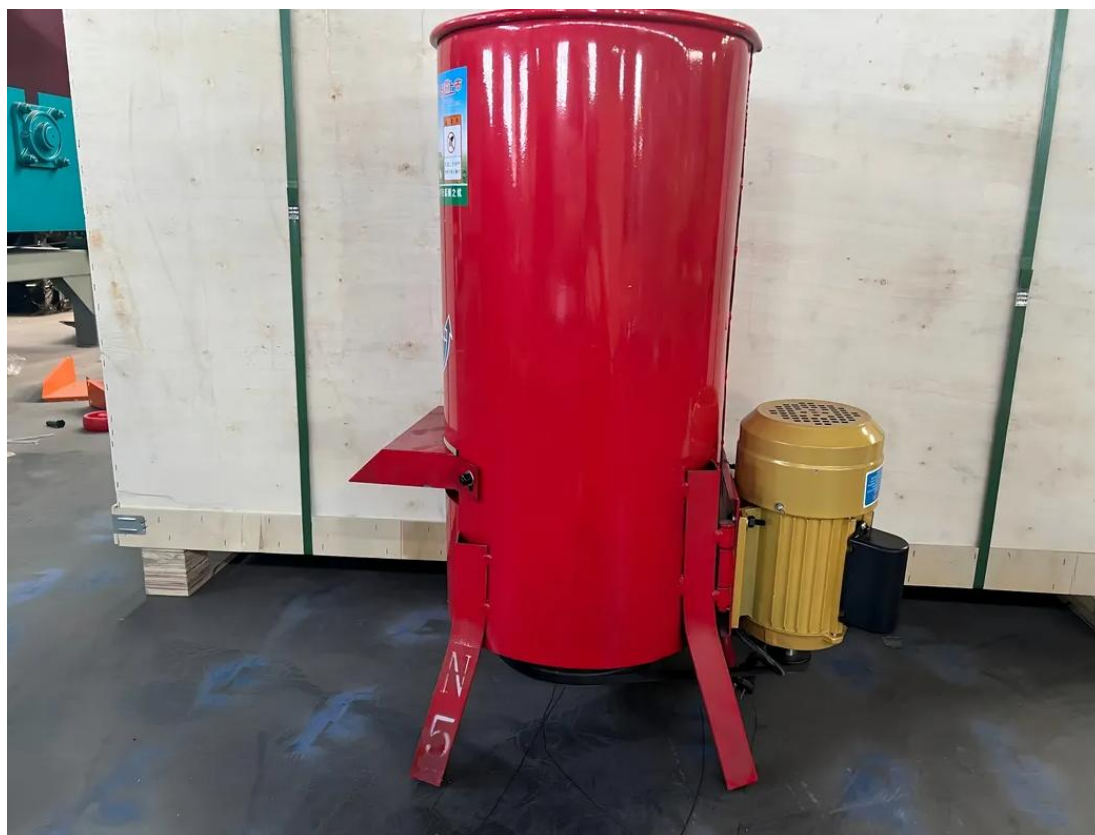
Fig. 3 - Vedere de ansamblu a utilajului, cu motorul electric montat lateral
