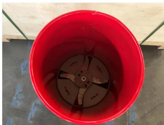
Fig. 2 – Motorul electric, discul cu cuțite, utilaje gata de livrare și vedere de sus în cilindru
